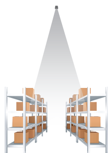
زاویه پخش تیز (N) 30 درجه
